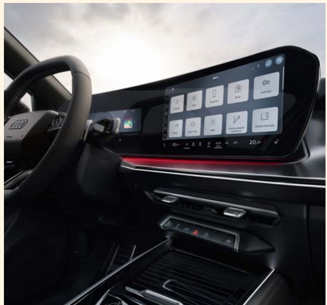
El sistema MMI Touch Display concentra las principales funciones de conectividad y multimedia mediante una interfaz táctil rápida e intuitiva.
