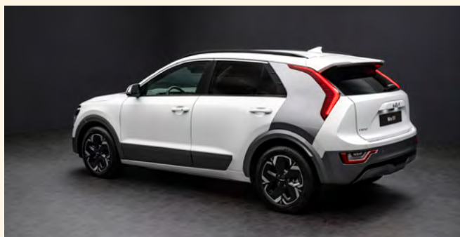
El perfil lateral del nuevo Kia Niro presenta un estiloso pilar C Aero en la parte trasera para mejorar el flujo de aire y la aerodinámica.
