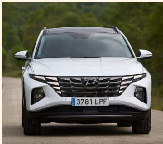
La parrilla frontal de aire activa ajusta la entrada de aire en función de la temperatura del refrigerante del motor, la velocidad del vehículo, etc.
