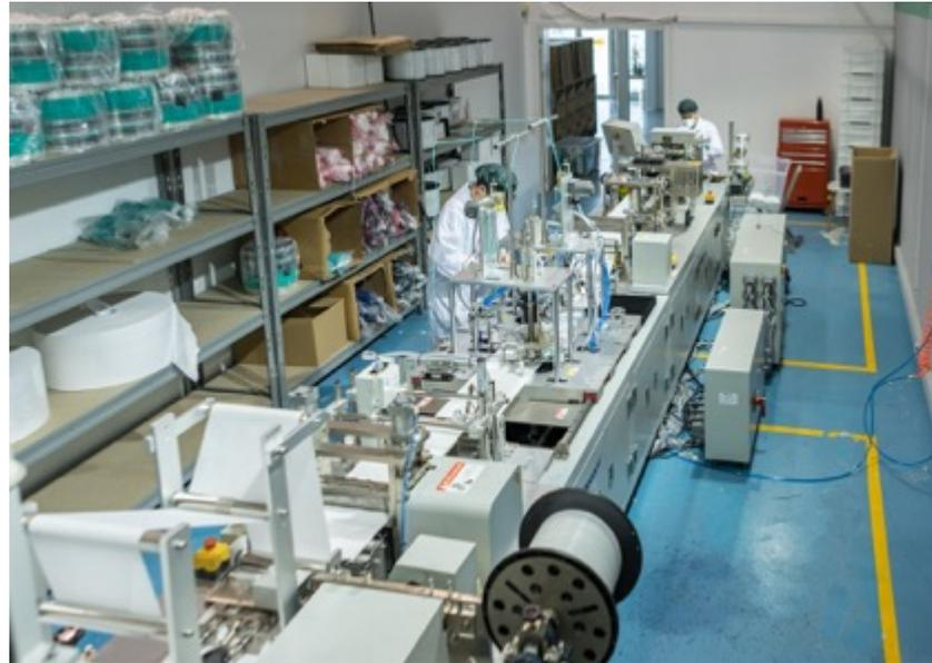
**Paso 2.** Calibrado del ultrasonido (sonotrono) para garantizar ajuste de la morfología y sellado/corte de la mascarilla.
