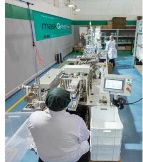
**Paso 0.** Encendido de la línea de producción (16 metros lineales con 8 estaciones) y comprobación de parámetros en monitor.
