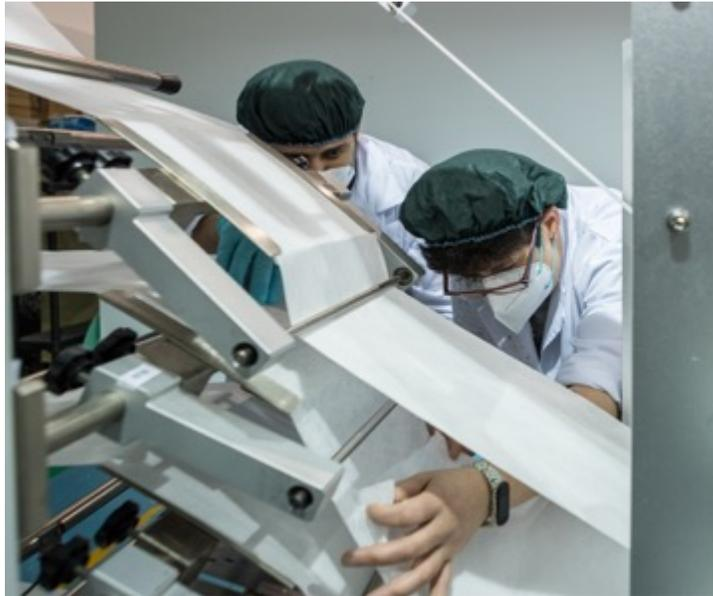
**Paso 1.** Ajuste de las “telas” que componen las 5 capas: trama, tensión, pliegues,... para una correcta entrada y termofusión.
