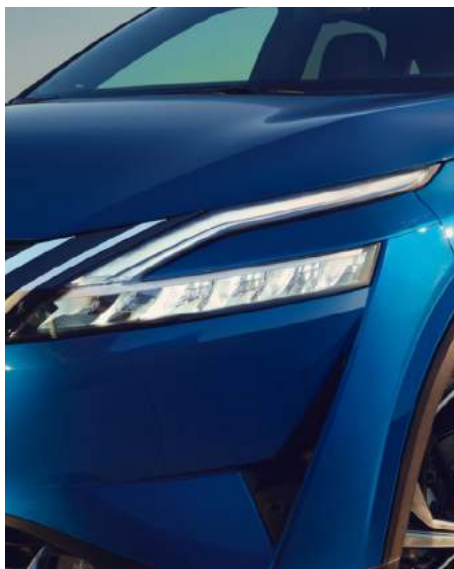
El haz de luz se divide en 12 elementos individuales que se desactivan selectivamente al detectar un vehículo que se aproxima.
