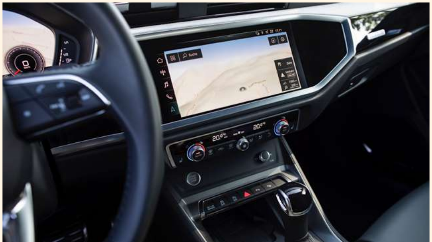
La instrumentación digital incluye pantalla de 25 cm de diagonal, que el conductor puede manejar con los controles del volante multifunción.
