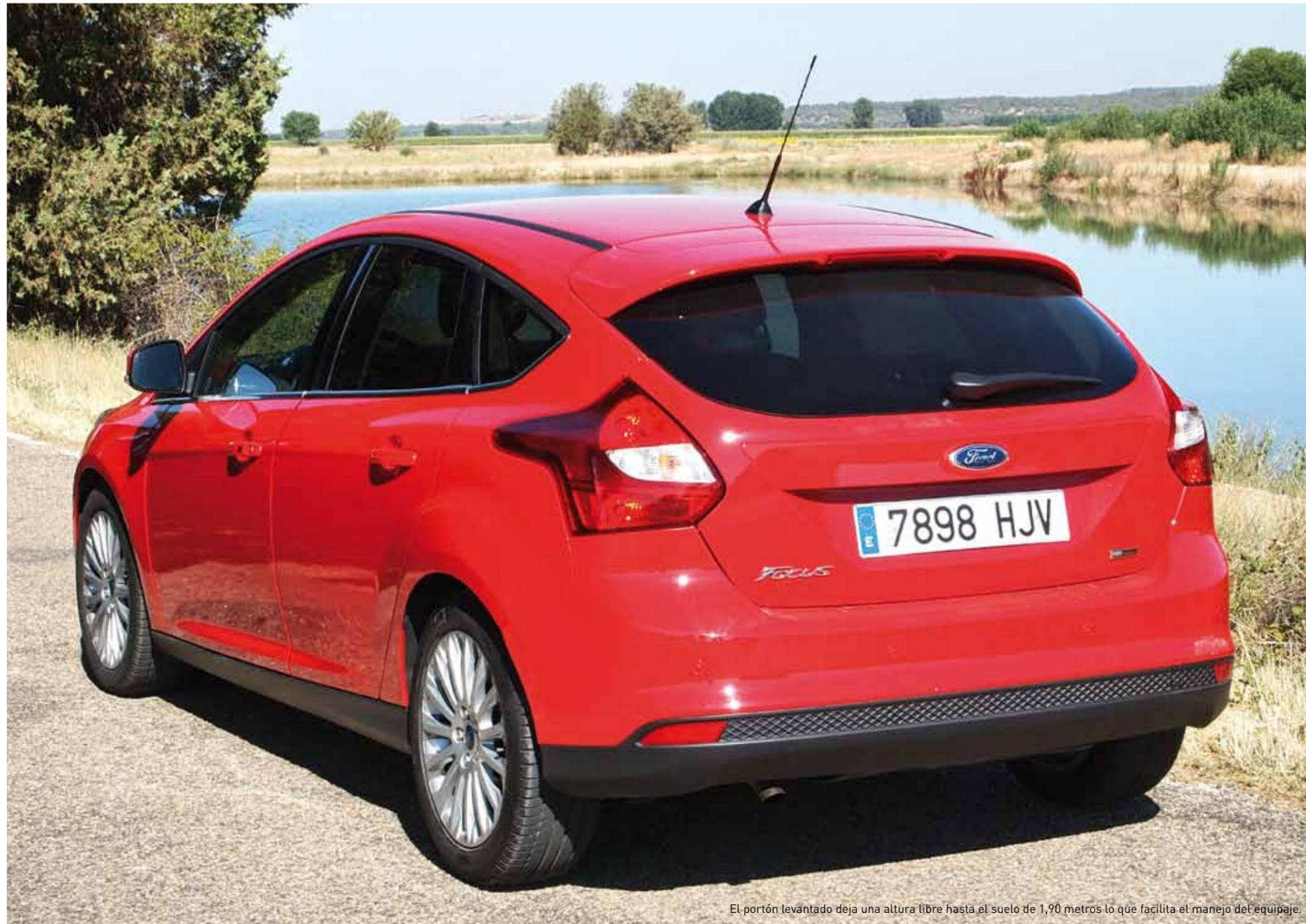
El portón levantado deja una altura libre hasta el suelo de 1,90 metros lo que facilita el manejo del equipaje.
