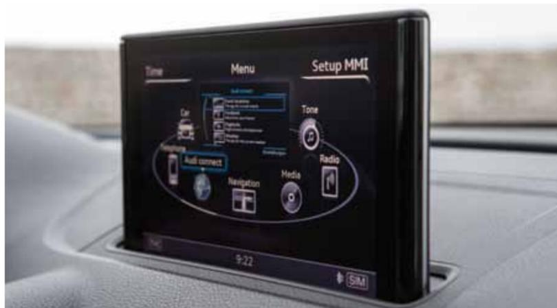
El sistema de manejo MMI, cuya pantalla se despliega eléctricamente, se monta de serie a partir del equipamiento MMI radio.
