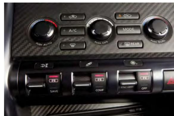
En la consola se pueden variar las distintas configuraciones de motor, transmisión y suspensiones.
