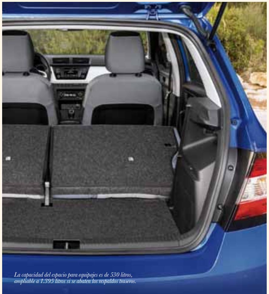
*La capacidad del espacio para equipajes es de 530 litros, ampliable a 1.395 litros si se abaten los respaldos traseros.*
