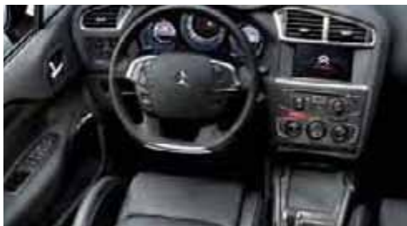
Materiales al mejor nivel del segmento: piel slush del cuadro de instrumentos o teclas cromadas, entre otras piezas.
