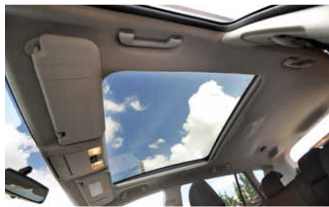
Techo panorámico de una sola pieza que incorpora una persiana eléctrica de láminas que se puede abrir hasta cualquier punto de su recorrido.
