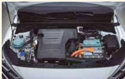
La propulsión está compuesta por un motor convencional 1.6 GDI de gasolina e inyección directa y un propulsor eléctrico de 61CV de potencia.
