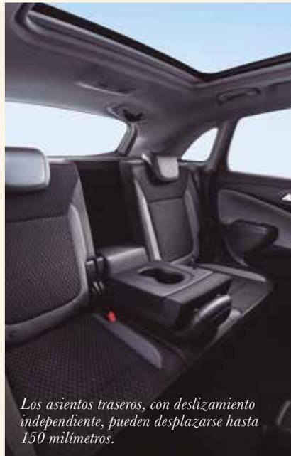
*Los asientos traseros, con deslizamiento independiente, pueden desplazarse hasta 150 milímetros.*
