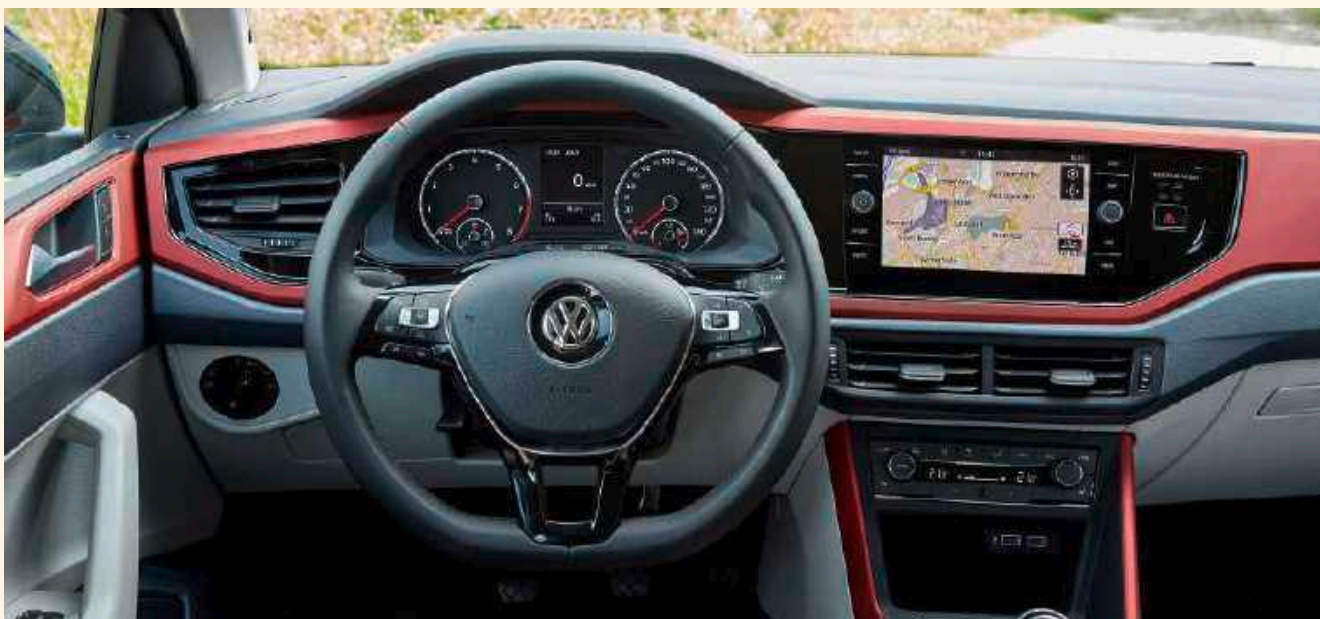
Todos los módulos importantes –exceptuando el climatizador– se han integrado en el perfil transversal superior del salpicadero.
